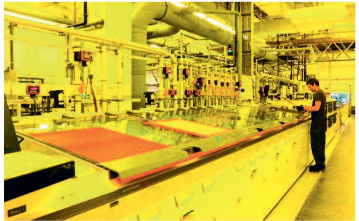
Die 30 Meter langen vollautomatischen DES-Linien (Develop-Etch-Strip) von KSG werden jeweils von einem einzigen Mitarbeiter bedient.
